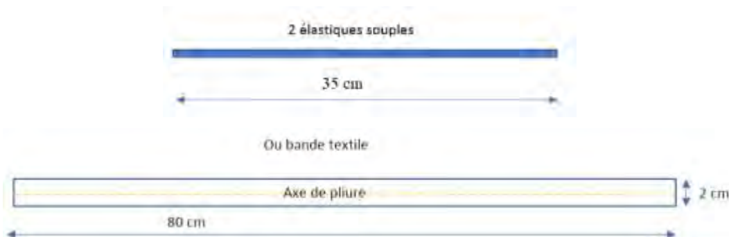
Figure 8 —à plis - Dimensionnement du jeu de brides
